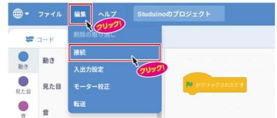
接続を選ぶと、下の画面のようなメッセージが表示されます。「USB -Serial Controller」を選択し、「接続」をクリックします。「テストモードに移行中」のメッセージが消えてセンサーボードが表示されると接続成功です。
