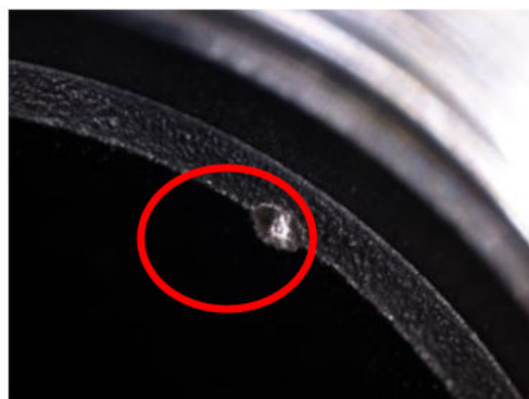
写真 2. ペン先接触部の摩耗
