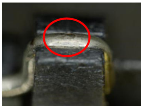
写真 1. 制御基板マイナス端子の摩耗
